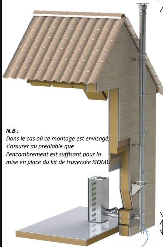
Raccordement en PLA  $\varnothing 80/125$
