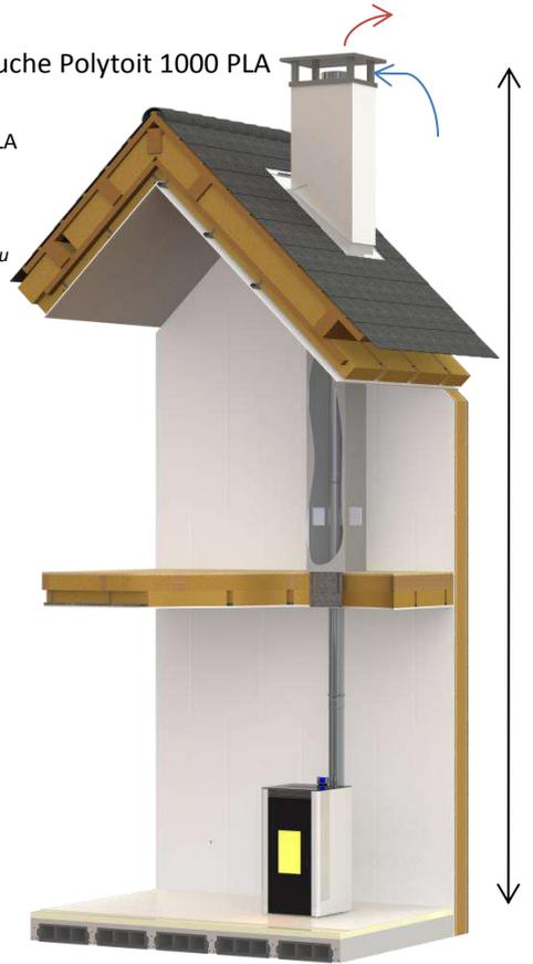
*jusqu'à 6m sans dévoiement en  $\phi 80$
